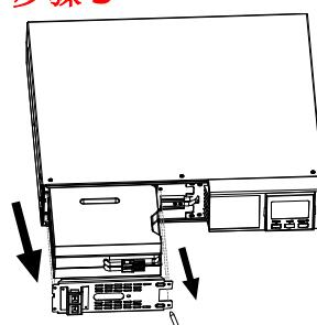
先将电池档板上的螺丝取下，移除电池档板后，将电池包拉出。
